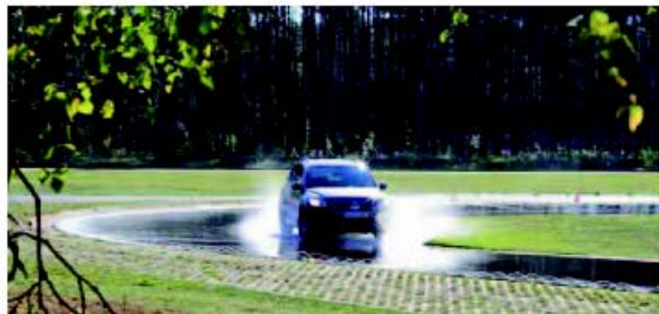
Okružní asfaltovou dráhou pokrytou vrstvou vody řidiči projíždí maximální rychlostí, již stabilita testovaného obutí umožňuje.
